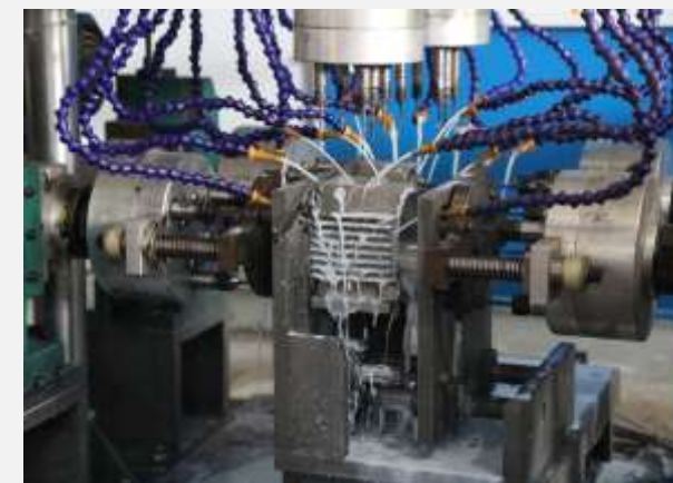
Fan Parts CNC Machining 负压风机零件数控加工
